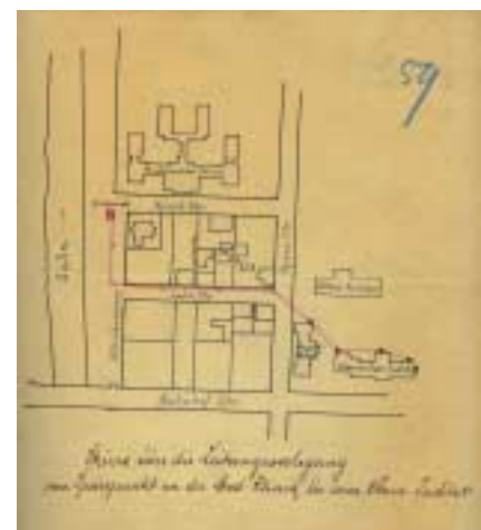
Skizze über die Leitungsverlegung vom Speisepunkt an der Med. Klinik bis zum Chem. Institut.
